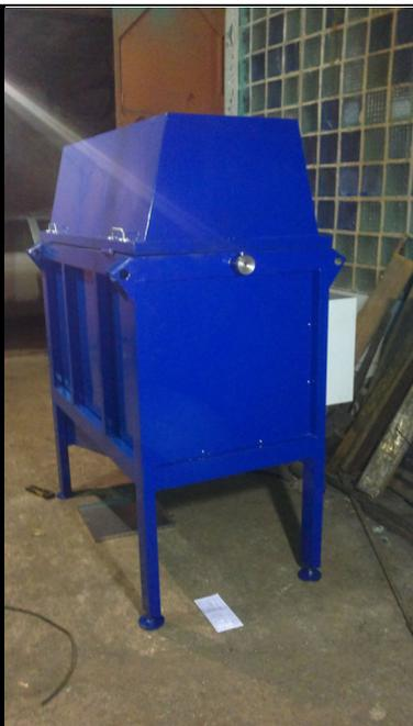
\* Зачистной блок для очистки кабеля от остатков изоляции.
