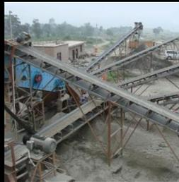
Ленточный конвейер (convey — продвигать) вид оборудования широко применяется на промышленных производствах, в рудниках и шахтах, в сельском хозяйстве. Служит для перемещения насыпных или штучных грузов. По требованию заказчика, могут состоять из:
