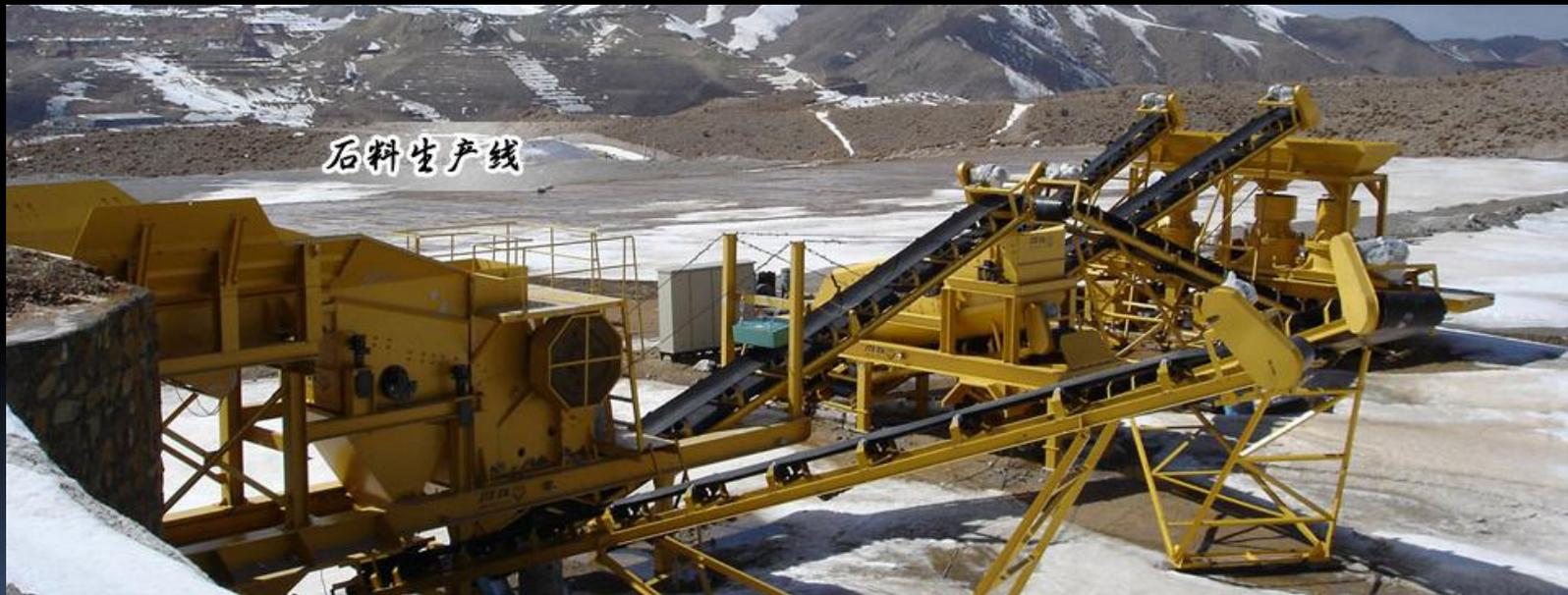
Комбинируя всё вышеперечисленное оборудование, можно создавать целые линии для выполнения Ваших задач. Разработки нашей компании позволили создать целые серии передвижных дробильно-сортировочных комплексов, которые на данный момент имеют массовый выпуск. Цель этих комплексов – ликвидировать препятствия, принесённые работой дробления, повысить эффективность, снизить себестоимость. Мобильность и компактные размеры, широкие возможности настройки в соответствии с требованиями клиентов.
