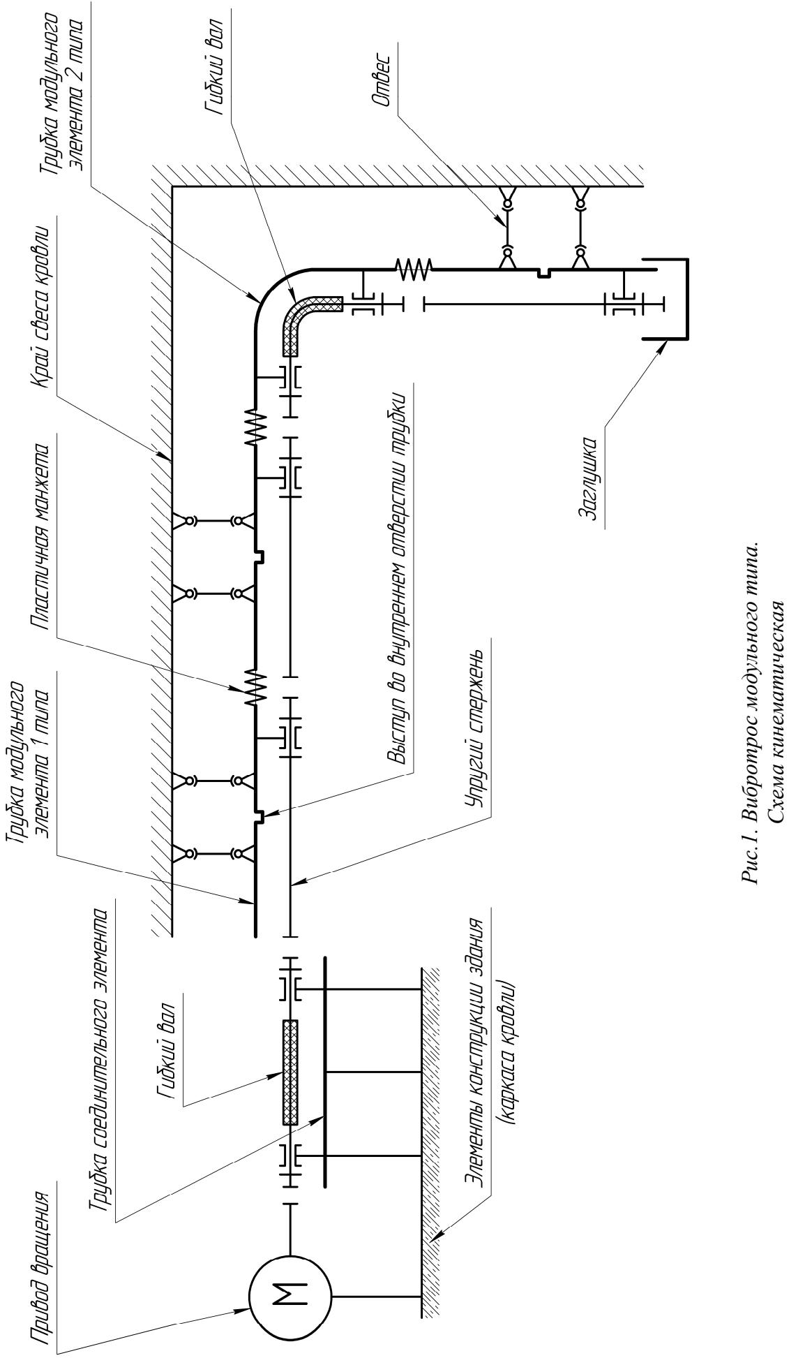
Рис. 1. Вибраторос модульного типа.
