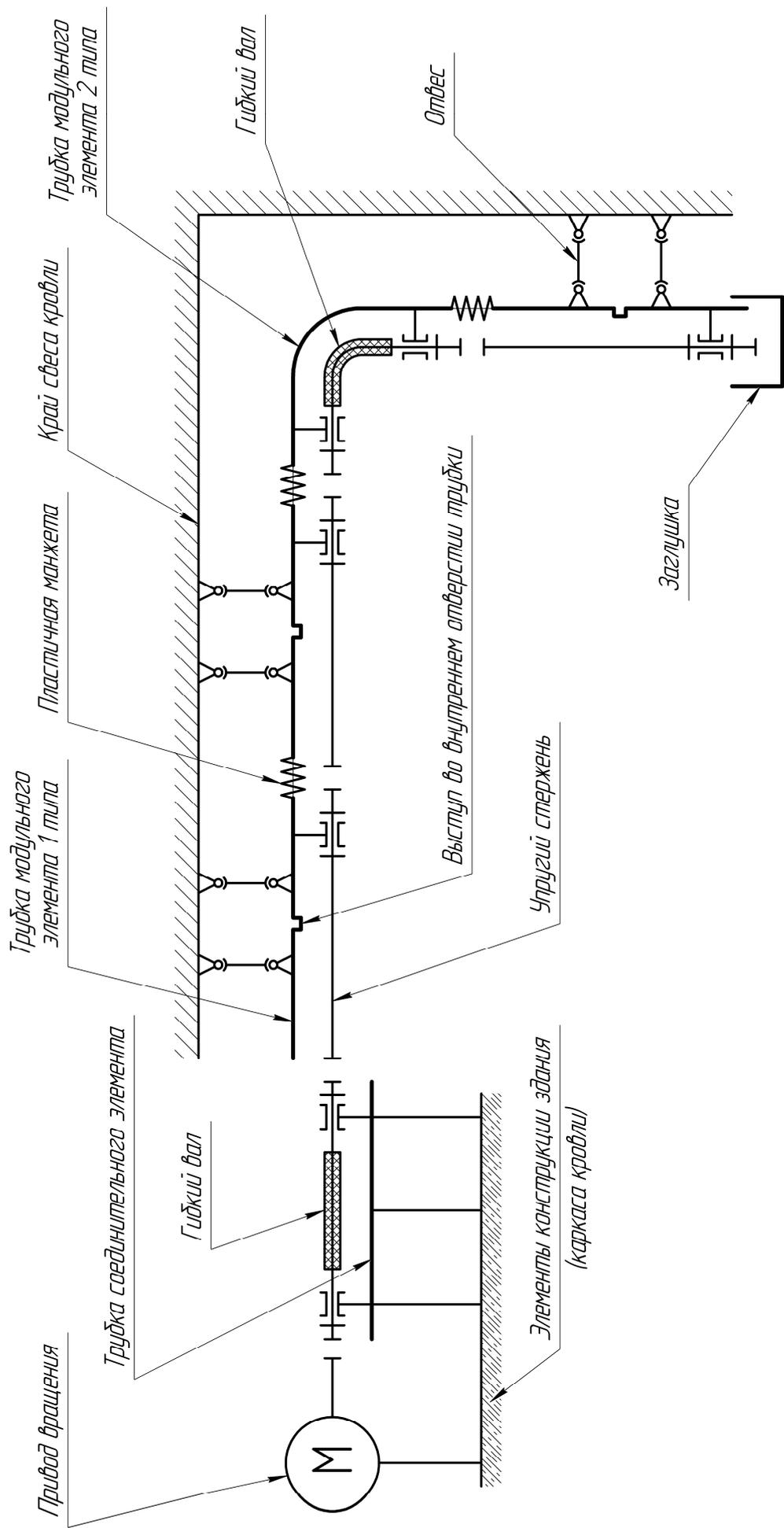
Рис. 1. Вибротрос модульного типа.
