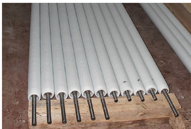
Валы, изготовленные методом ротационного литья
