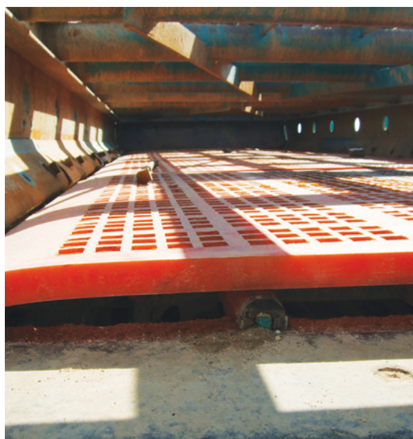
Замена изношенных сит из стальной сетки на натяжные полиуретановые сита на грохоте Metso Nordberg
