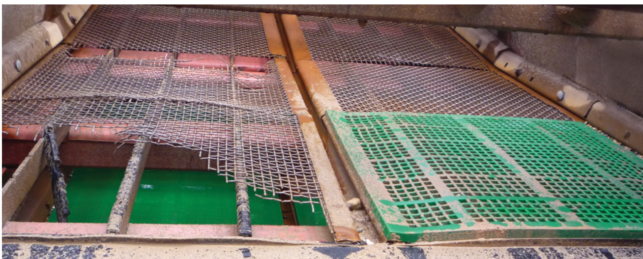
Замена изношенных сит из стальной сетки на натяжные полиуретановые сита на грохоте Metso Nordberg
