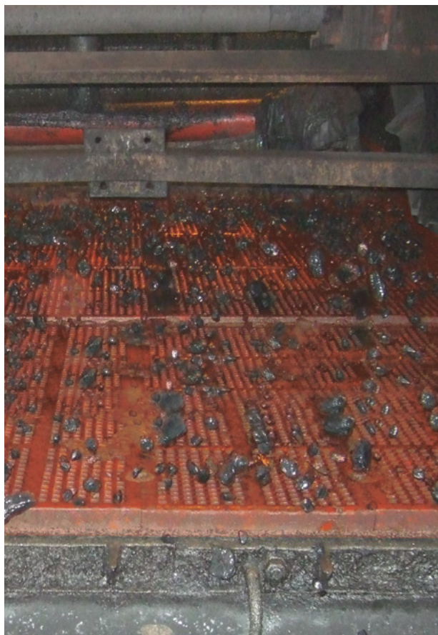
Грохот инерционный ГИТ-72, сортировка угля, дека оснащена полиуретановыми ситами с квадратной ячейкой 16x16 мм.
