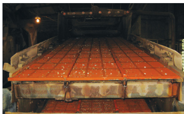
Грохот инерционный двухдечный - ГИЛ52, установлены сита с ячейкой 20x20 мм (верхняя дека) и 5x5 мм (нижняя дека). Монтаж выполнен с использованием прижимной планки
