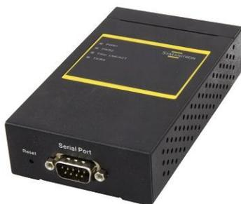
Серверы последовательных интерфейсов Symanitron предназначены для передачи информации между Ethernet и последовательными интерфейсами RS232/422/485. Сервера могут обмениваться данными с пятью хостами. Эта функция служит для резервирования всех важных данных на разных хостах, на случай обрыва связи или выхода из строя одного хоста.
