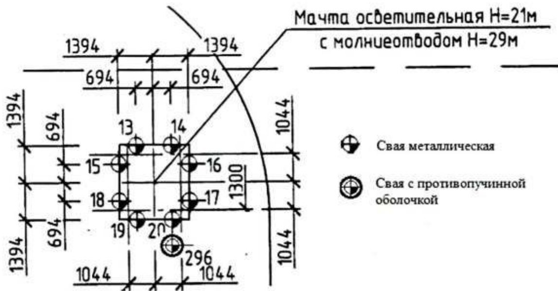
Рис. 2 Схема расположения свайного поля мачты осветительной с молниеотводом
