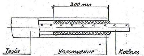
Уплотнение трубы выполнить из джутовых переплетенных шнуров покрытых водонепроницаемой (мятой) глиной.
