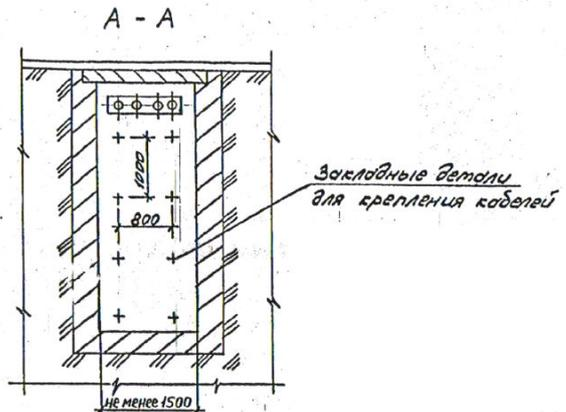
1. Вводы кабелей в здания, кабельные сооружения и другие помещения должны быть выполнены в асбестоцементных безшпартных трубах в отфрантованных отверстиях железобетонных конструкций
