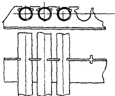
Рисунок 4 – Схема крепления полиэтиленовых труб для электропроводок в уголках из листовой стали с фасонными вырезами
