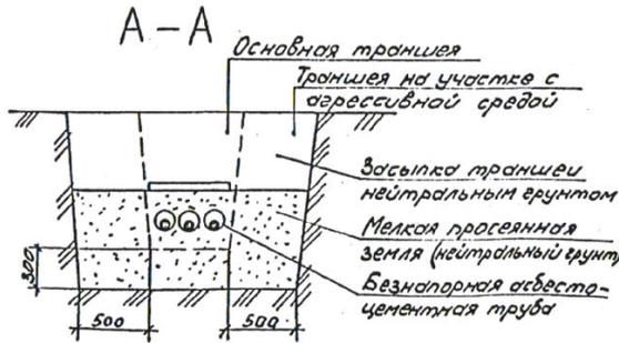
1. Асбестоцементная труба должна быть покрыта снаружи и внутри битумным составом
