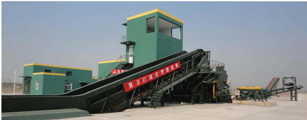
Шредерная линия по переработке цветного лома (алюминия)
