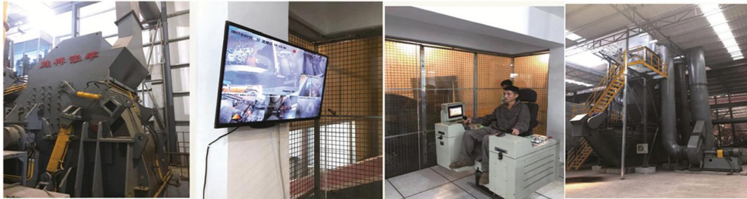
Шредерная линия по переработке цветного лома (алюминия)
