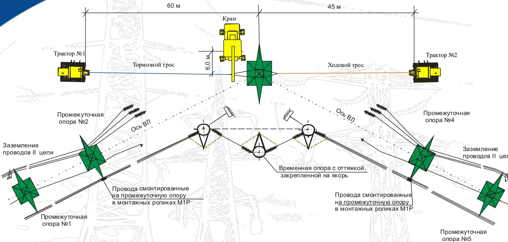
Схема участка ВЛ с расстановкой механизмов при проведении работ по демонтажу (монтажу) анкерной опоры для ВЛ 220 кВ
