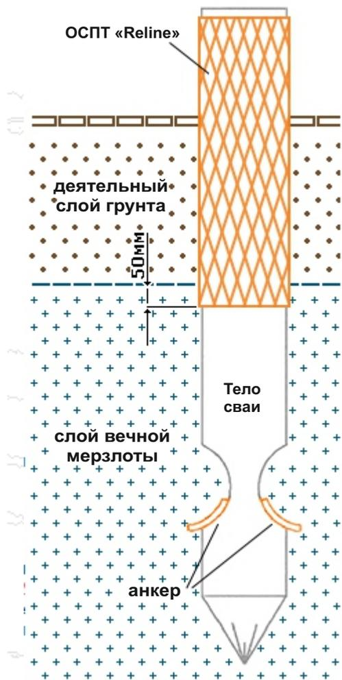
Для прокладки промышленных трубопроводов в условиях крайнего Севера РФ ЗАО УЗПТ «Маяк» производит противопучинные сваи серии СМОТ с противопучинной оболочкой ОСПТ «Reline» (Серия 1.411.3-11см.13). Специально разработанные сваи являются основой для опор надземных нефте- и газопроводов в районах вечной мерзлоты.
