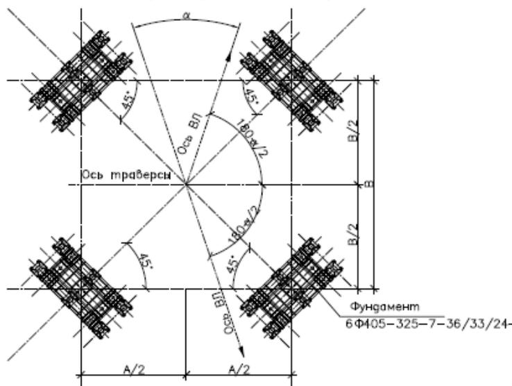
Схема нагрузок на фундамент опоры
