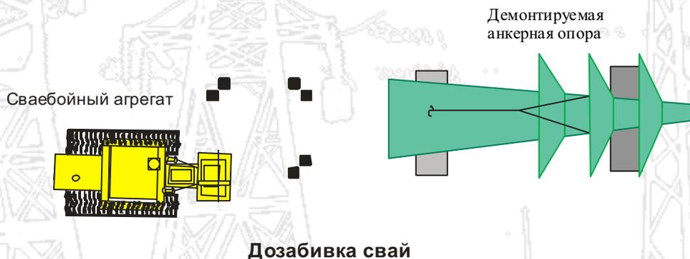
Схема демонтажа (монтажа) анкерной опоры ВЛ 220 кВ краном и тракторами.
