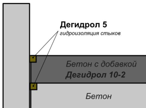
Если имеется опасность подвижек в стыках, то такие стыки гидроизолируют с помощью эластичного гидроизолирующего материала Дегидрол люкс марки 7 с финишной защитной заделкой Дегидролом люкс марки 5:
