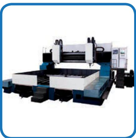
Оборудование предназначено для сверления глухих и сквозных отверстий, зенкования, развертывания, зенкерования и нарезания внутренней резьбы в листовом прокате.
