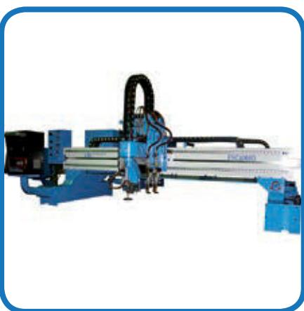
Установка для термической резки листового проката предназначена для раскroя листового проката из черных и цветных металлов и сплавов.
